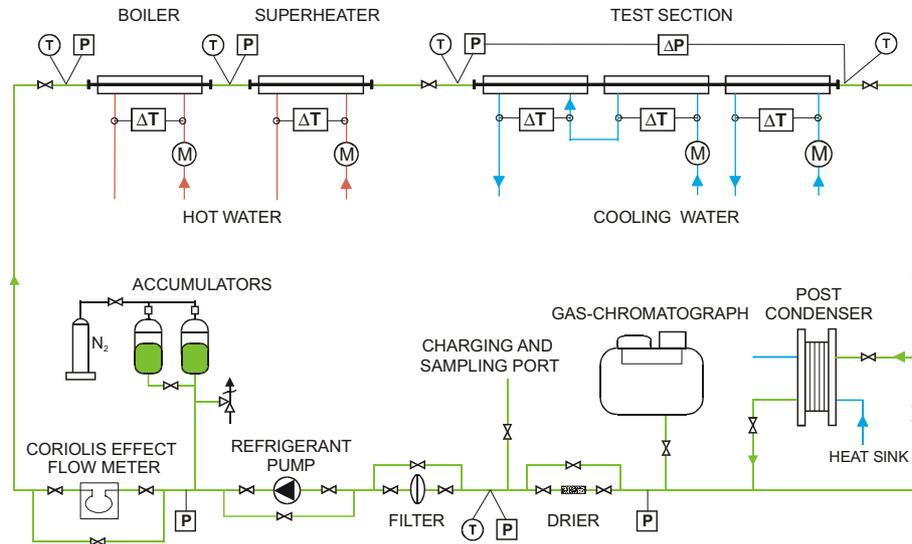
Fig. 2. Experimental test rig.
